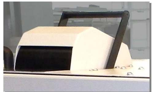
Optional: Sondertrichter mit elektrischer Verriegelung/Freigabe für Aufgabe der nächsten Festplatte und Zählrichtung
