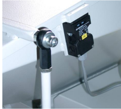
Sicherheitsschalter am Trichterdeckel
