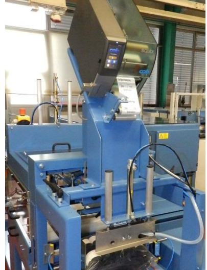
Option: Barcode-Drucker für Selbstklebe- Etiketten, die auf dem Tütenboden angebracht werden
