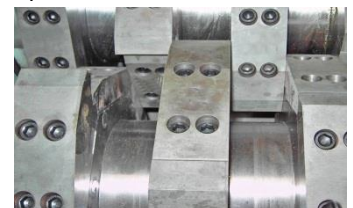
Segmentmesser, in der Maschine tauschbar ohne Ausbau der Messerwellen
