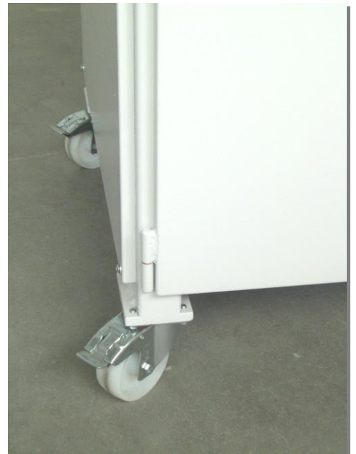
Maschine steht auf lenkbaren Laufrollen
