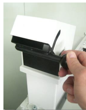
Sondertrichter zur manuellen Aufgabe der Festplatten
