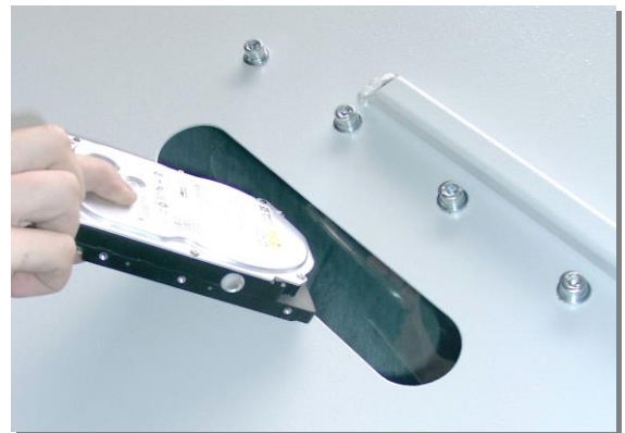
Einwurfschlitz für kontinuierliche Zuführung des Schnittgutes
